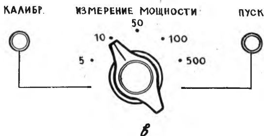
Р и с. 21. Графическое оформление функциональной связи линиями: а - разделительными; б - объединительными; в - соединительными
