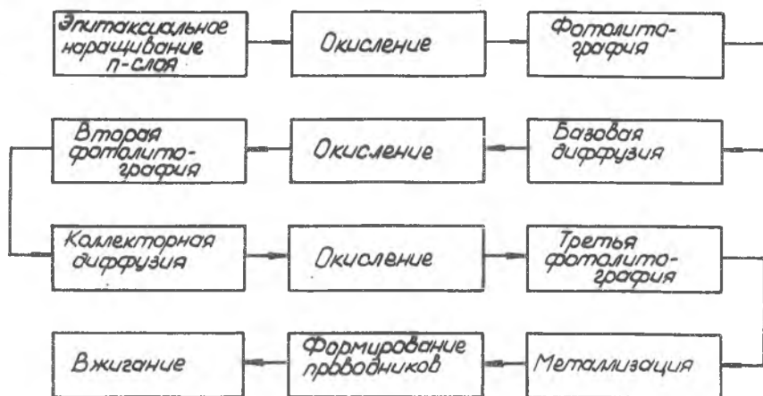
Р и с. 2. Схема технологического процесса изготовления И 2 Л - структуры
