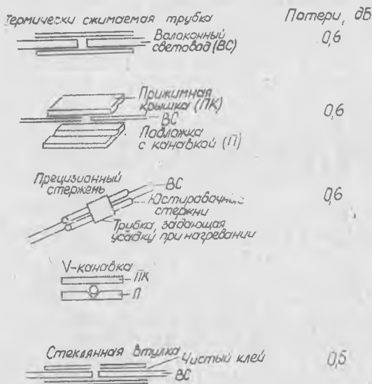
Р и с . 5. Различные методы соединений волоконных световодов
