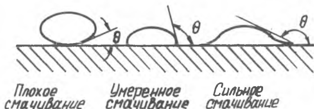
Р и с. I. Смачивание металла припоем
