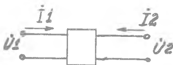
Р и с. I. Представление УНЧ в виде четырехполюсника
