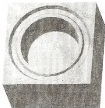
Рис. 17. Модель штампа после выполнения операции "Вырезать вращением"
