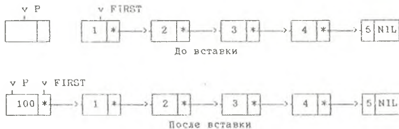
Р и с. 5. Вставка узла в начало списка
