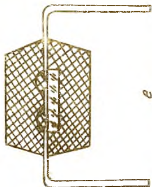
Р и с. 5. Конструкция корпусов: а - металlostеклянный; б - стеклянный; в - керамический; г - металлополимерный; д - пластмассовый; е - полимерный
