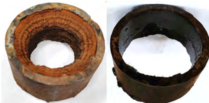
Рисунок 2 – Образец трубы с асфальтосмолопарафиновыми отложениями, слева – до обработки, справа – после
