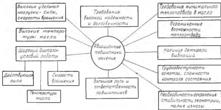
Рис. 5. Структурная схема особенностей работы авиационных подшипников
