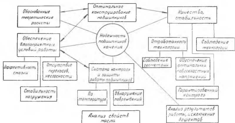
Рис. 8. Структурная схема мер по обеспечению надежности работы подшипников качения
