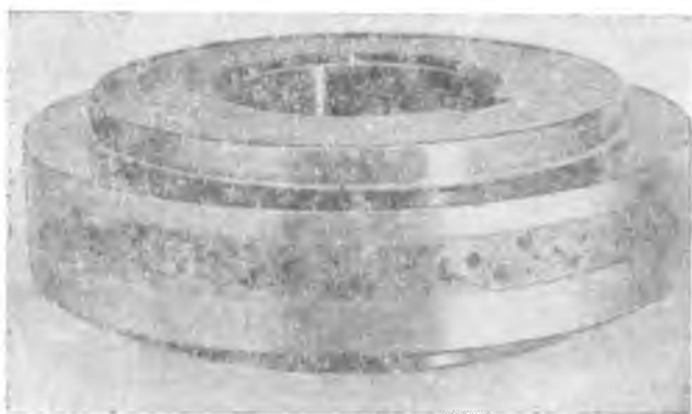
Рис. 4. Образец из стали 40Х (НВ240—260) с пittingом на беговой дорожке.
