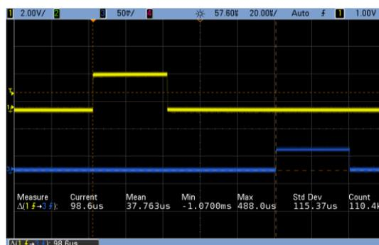
**Рисунок 1:** Временное прохождение сигнала через имитатор с задержкой на 98.6 мкс. Цена деления по горизонтали 20 мкс
