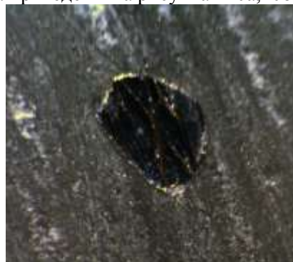
Рисунок 10. Внешний вид единичного отверстия с дефектом формы на границе образца (в объеме отверстие имеет цилиндрическую форму) после заполнения сплавом Вуда. Диаметр отверстия 1,2 мм.
