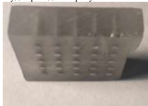
Рисунок 8. Внешний вид образцов после заполнения отверстий сплавом Вуда. Диаметр отверстий 1,2 мм.
