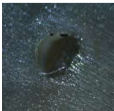
Рисунок 6. Единичное отверстие диаметром 0,8 мм.
