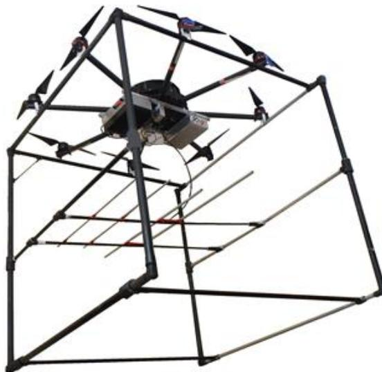
Рис. 2. Внешний вид PCA VHF диапазона на базе октокоптера
