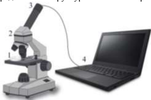
Рисунок 1. Схема лабораторной установки для анализа пленок биологических жидкостей: 1 – кювета с образцом; 2 – оптический микроскоп; 3 – камера; 4 – компьютер.
