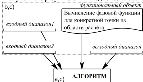
Рисунок 12. Диаграмма взаимодействия компонентов при мультипарадигменном подходе: а) – процедурная парадигма; б) – объектно-ориентированная парадигма; с) – обобщённая парадигма.
