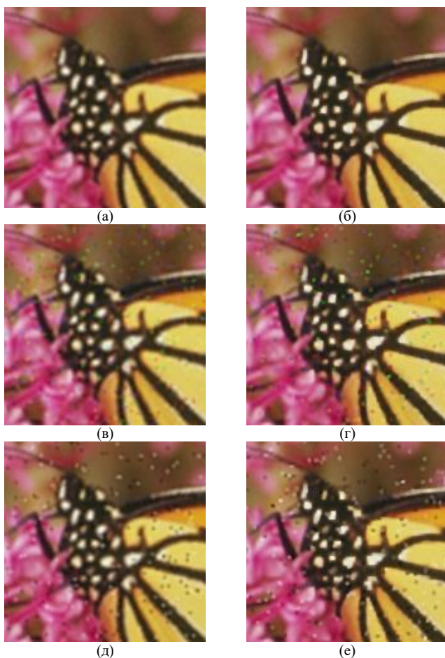
Рис. 2. Результат восстановления для различных видов шумов и регуляризации: (а) аддитивный шум, L2 регуляризация, (б) аддитивный шум, функция Хьюбера, (в) импульсный шум послыбно, L2 регуляризация, (г) импульсный шум послыбно, функция Хьюбера, (д) импульсный шум, L2 регуляризация, (е) импульсный шум, функция Хьюбера
