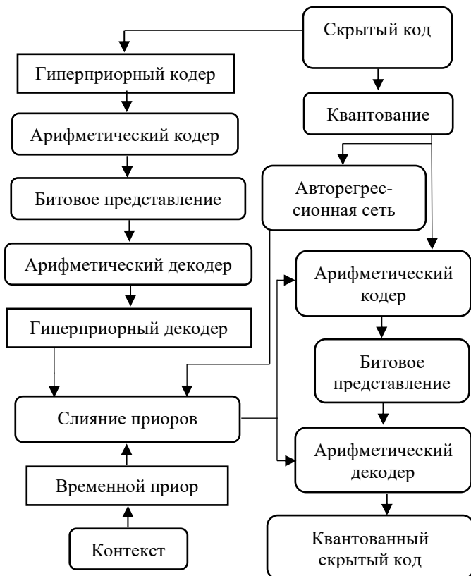
Рис. 2. Схема энтропийной модели, используемой в методе глубокого контекстуального сжатия видео
