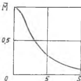
Р и с.2. Влияние величины магнитного поля на расход жидкости между пластинами
