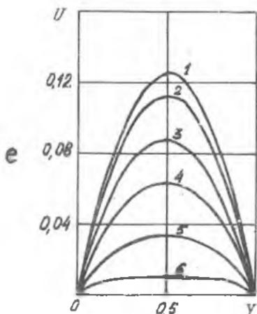
Р и с. 1. Влияние температуры стенок и величины магнитного поля на профиль скорости: а -  $z = 0$ ; б - 0.2; в - 0.4; г - 0.6; д - 0.8; е - 1.0; 1 -  $s = 0$ ; 2 - 1; 3 - 2; 4 - 3; 5 - 5; 6 - 10
