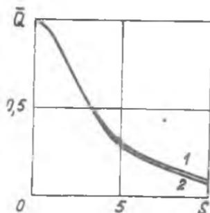
Р и с.3. Влияние температуры стенок и величины магнитного поля на поглощаемое жидкостью тепло: 1 -  $z = 0$ ; 2 - 1
