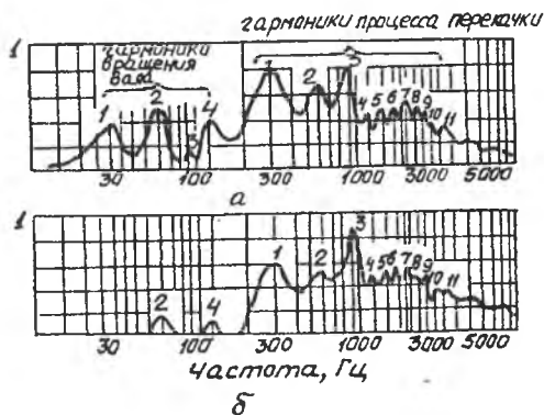
Р и с. I. Спектры уровней пульсаций, вибраций и шума, производимых насосом: а – энергия пульсаций и вибраций; б – звуковая энергия
