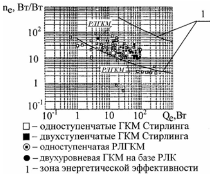
Рис. 21 — РЛГКМ в поле энергетических характеристик серийных ГKM Стирлинга
