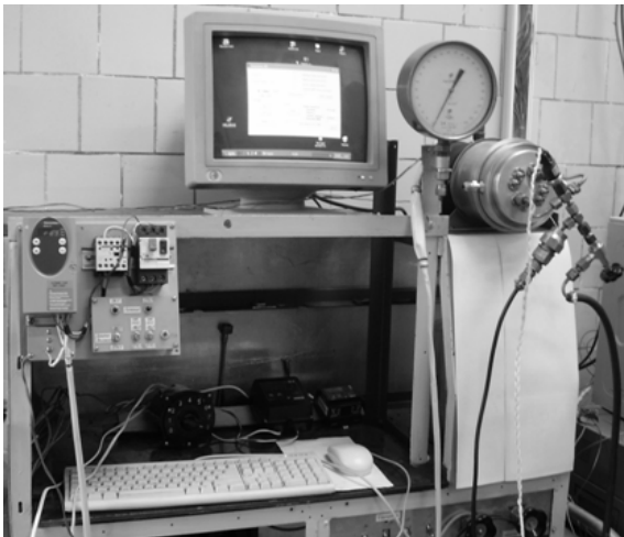
Рис. 13 — Внешний вид установки для испытаний роторно-лопастного компрессора с присоединенным объемом
