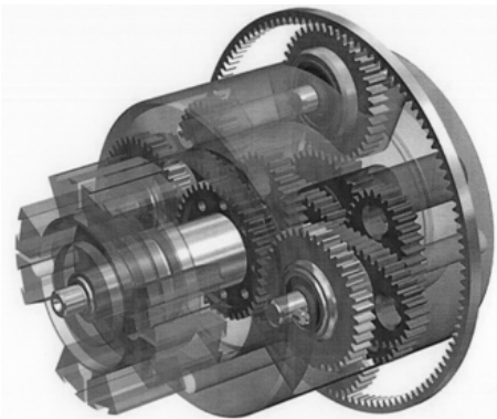
Рис. 2 — «Колеблющийся» вариант роторно-лопастного компрессора
