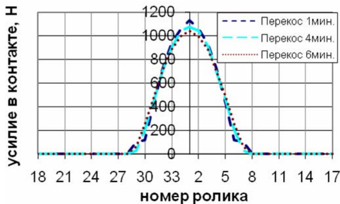
Рис.4. Распределение нагрузки по телам качения подшипника при нагрузке F_r = 7 кН
