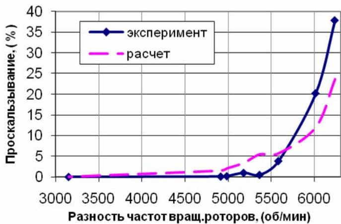
Рис. 10. Зависимость скольжения сепаратора от разности частот вращения колец при g = 43 мкм и
