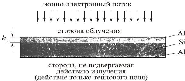
Рисунок 14 – Косой шлиф микроструктуры алюминий – кремний – алюминий после обработки при одной и той же температуре, равной 1123 К, верхней стороны плазмой, а нижней – тепловым полем
