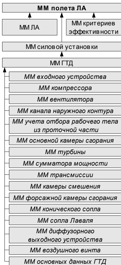
Рисунок 1 — Иерархия математических моделей в задаче моделирования полета ЛА
