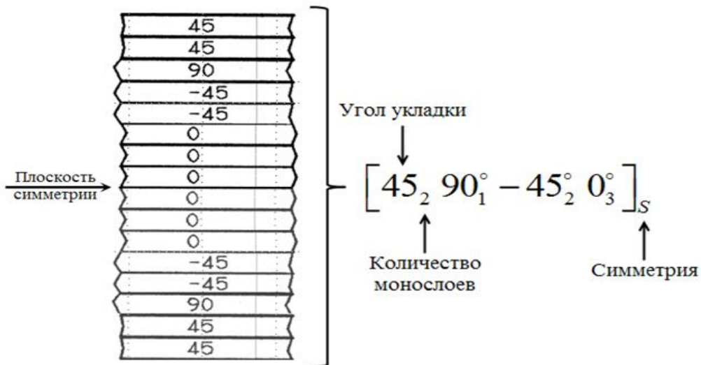
Рисунок 2 – Конструктивно-технологическая схема кодирования параметров и структуры многослойного композита
