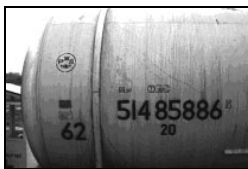
Рис. 12. Информация о цистерне: восьмизначный номер, тип (62) и код принадлежности стране (20). Номер распознается автоматически (если удастся), тип и код принадлежности берутся из базы данных по вагонам.
