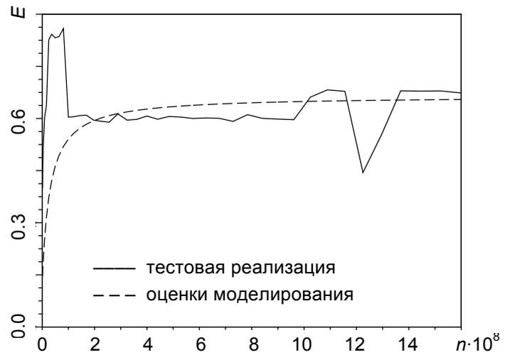
Рисунок 5 – Зависимость эффективности от размера изображения с учетом операций ввода/вывода
