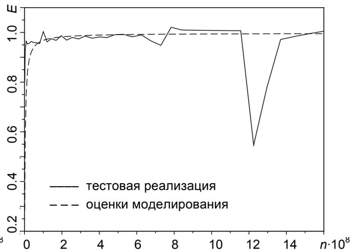
*Рисунок 3 – Зависимость эффективности параллельной обработки от размера изображения*
