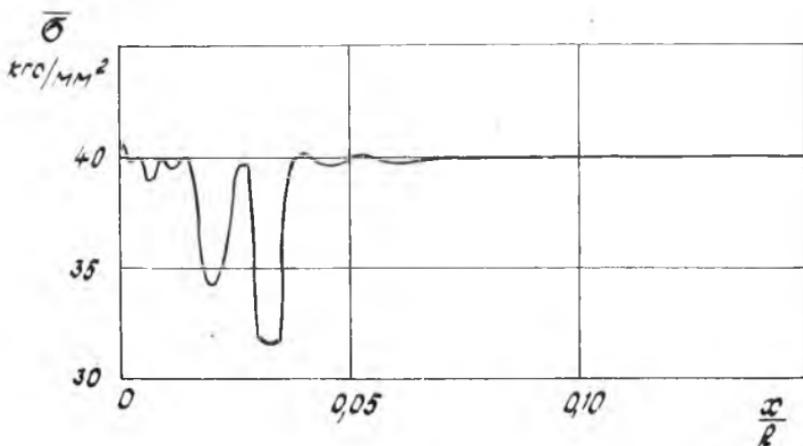
Р и с. 4. Зависимость приведенного напряжения  $\bar{\sigma}$  дискретно-равнопрочной цилиндрической оболочки от отношения ее осевой координаты  $x$  к радиусу  $R$
