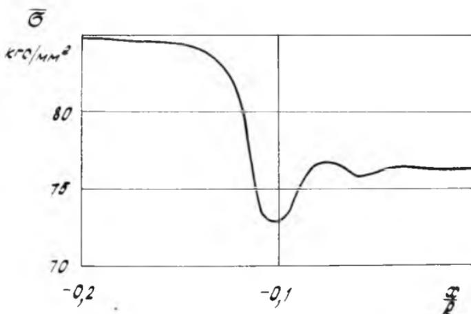
Р и с. 7. Зависимость приведенного напряжения  $\bar{\sigma}$  дискретно-равнопрочного шар-баллона от отношения его осевой координаты  $x$  к внутреннему радиусу  $R$
