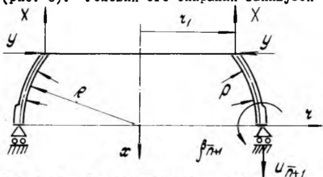
Р и с. 6. Расчетная схема шар-баллона
