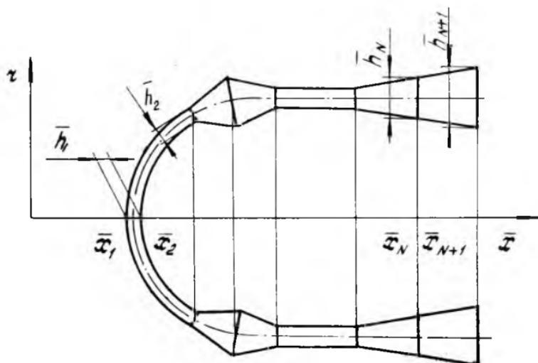
Р и с. I. Схема разбиения оболочки вращения на подконструкции
