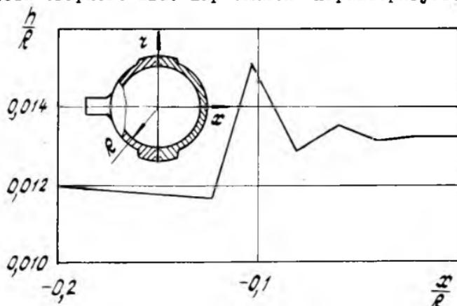
Р и с. 5. Зависимость отношения толщины  $h$  дискретно-равнопрочного шар-баллона к его внутреннему радиусу  $R$
