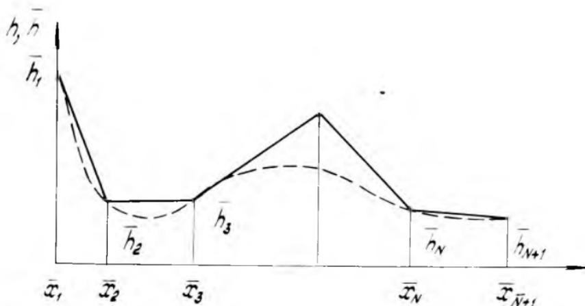
Р и с. 2. Схема определения распределения толщины дискретно-равнопрочной оболочки
