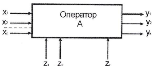
Рисунок 1 – Объект испытаний – динамическая система
