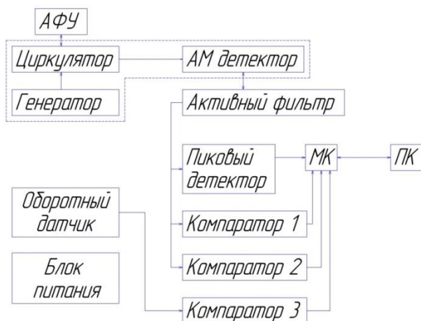
Рисунок 1 – Структурная схема экспериментального устройства
