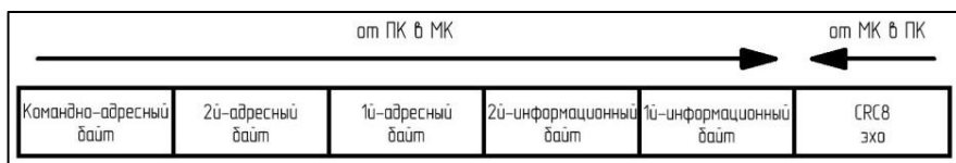
Рисунок 3 – Формат пакета программирования микроконтроллера
