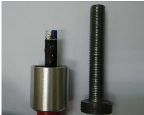
Рисунок 2 - Оптоэлектронный преобразователь перемещения на основе фототранзистора в разобранном виде
