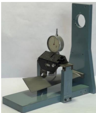
Рисунок 1 – Экспериментальная установка для измерения профиля лопатки с нониусным и микрометрическим индикаторами
