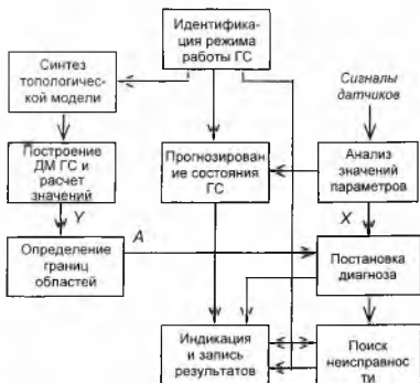
Рис 2 Логическая схема работы системы диагностирования ГС ЛА
