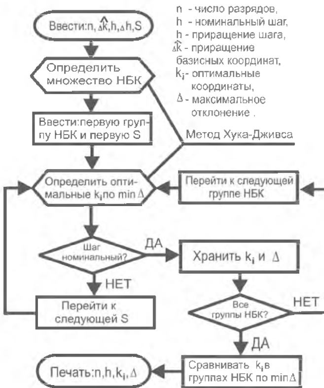
Рис.2. Алгоритм модифицированного метода Хука-Дживса
