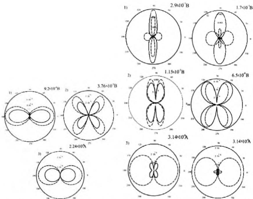
Рис.3. Распределение величин  $r/\lambda_0 aE_z$  (цифры 1) и  $r/\lambda_0 aE_\theta$  (цифры 2),  $r/\lambda_0 aH_\theta$  (цифры 3) для электрического вибратора от координаты  $\Theta$  при различных расстояниях  $r = \sqrt{\rho^2 + z^2}$  от него: а)  $r/\lambda_0=0,3$ ; б)  $r/\lambda_0=3,5$ ; в)  $r/\lambda_0=3$ , (сплошные линии – реальные части величин, пунктирные линии – мнимые части величин)
