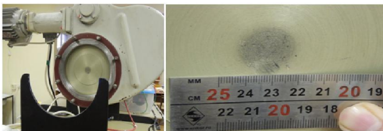
Рисунок 2 – Закрытая задвижка тракта ускорителя и распределения частиц по тракту (пятно на задвижке)
