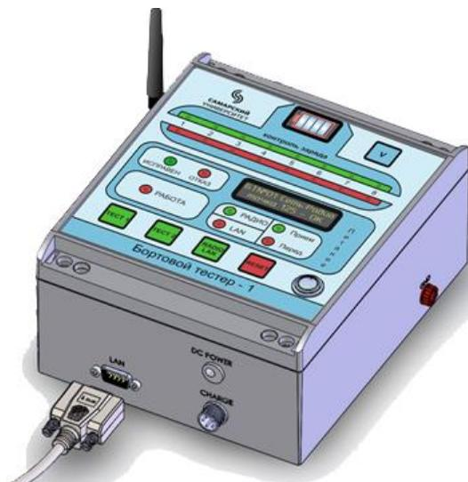
Рисунок 1 – Модуль системы контроля жгутовых соединителей
