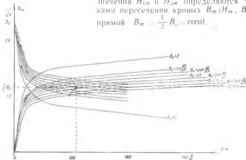
Рис. 5. Семейство кривых одновременного намагничивания для стали Э-330 с толщиной ленты 0,08 м.м.
