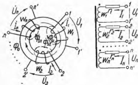
Рис. 1. Схема трансформатора с неразветвленной магнитной цепью
