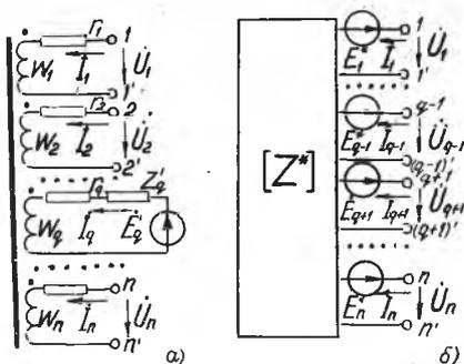
Рис. 2. Схема трансформатора и ее эквивалентная модель
